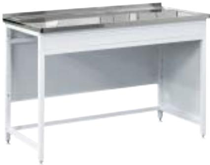
**Предназначены** для организации рабочих мест лаборантов, для размещения различных приборов и оборудования при проведении физических и химических исследований. Выдерживают распределенную нагрузку на столешницу от 200 кг (200 даN) до 300 кг (300 даN) в зависимости от модели. Суммарная мощность нагрузки на розетки — 2200 ВА, автомат отключения питания — 10 А.
