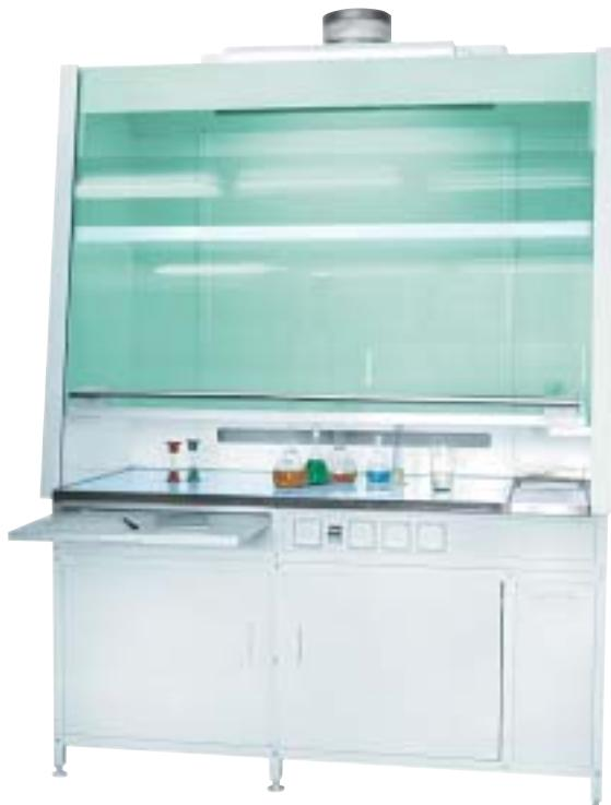
**Предназначены** для проведения работ по органическому синтезу и с вредными химическими веществами, нефтепродуктами, растворителями, легко воспламеняющимися жидкостями, тяжелыми газами, кислотами и щелочами. Шкафы оборудованы ударостойкими подъемными экранами из стекла «триплекс» с максимальной высотой подъема 600 мм, вытяжкой из нижних тумб. Устанавливаются на регулируемые опоры.
