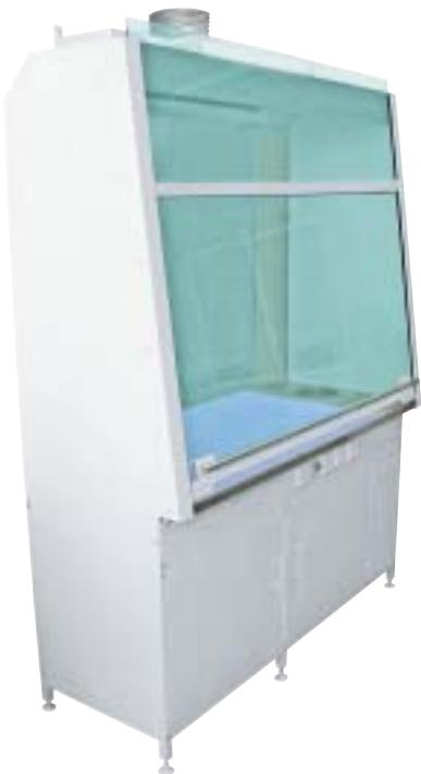
**Предназначены** для проведения работ по органическому синтезу и с вредными химическими веществами, нефтепродуктами, растворителями, легко воспламеняющимися жидкостями, тяжелыми газами, кислотами и щелочами. Шкафы оборудованы ударостойкими подъемными экранами из стекла «триплекс» с максимальной высотой подъема 600 мм, вытяжкой из нижних тумб. Устанавливаются на регулируемые опоры.
