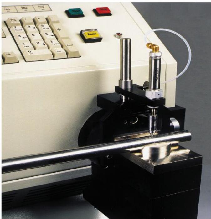
Одним из многочисленных специальных предложений от **Belec** является оборудование стационарного прибора **зондом**. Без каких-либо изменений в конструкции спектрометра это дает возможность точно анализировать тяжелые и громоздкие детали, проводить сортировку и быструю отбраковку материала.
