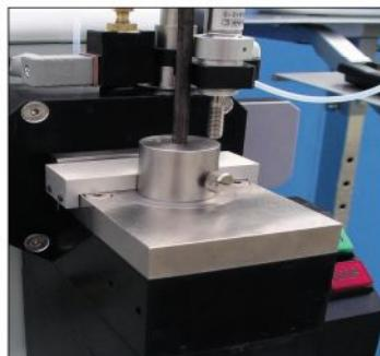
Для анализа поверхности проволоки диаметром от 0.5 мм до 2 мм в компании **Belec** разработан специальный адаптер, позволяющий зафиксировать несколько отрезков проволоки и обеспечить нужную поверхность для измерения.
