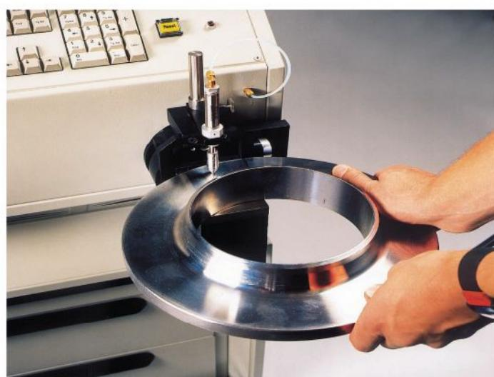
Открытый искровой штатив спектрометра **Belec Vario Lab** имеет свободный доступ со всех сторон, что даёт возможность, не разрезая, анализировать большие и громоздкие детали, и многократно повышает пропускную способность прибора в режимах сортировки и отбраковки.
